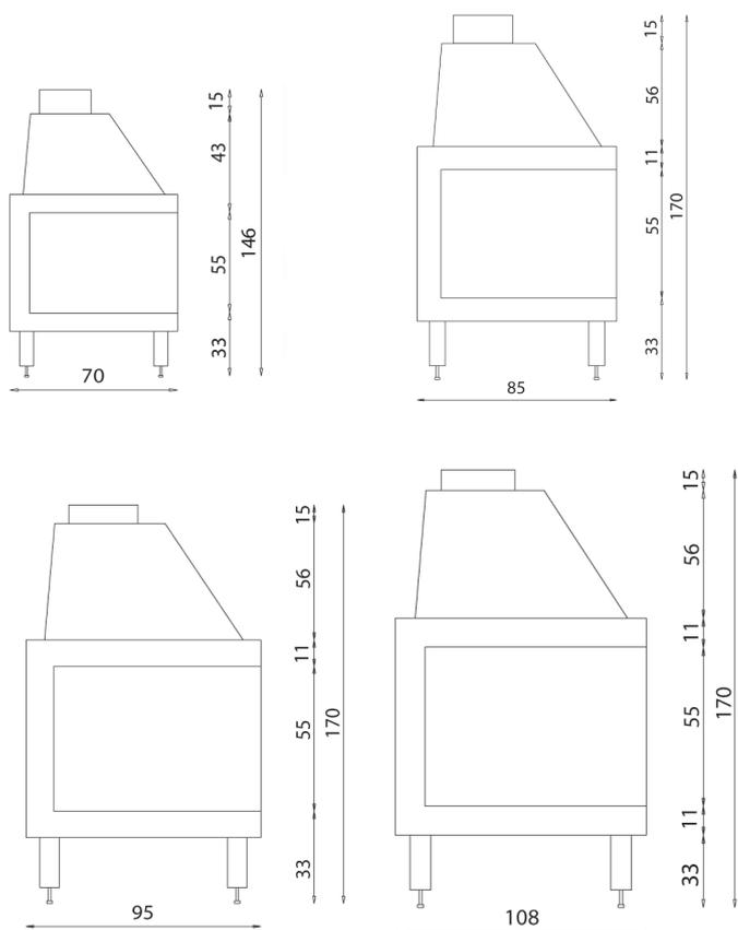
Il modello **angolare** della serie **master S** è il prodotto ideale per chi vuole un camino pratico, funzionale e duraturo. È un focolare angolare di grandi dimensioni, totalmente in ghisa, dotato di cassetto cenere e registro fumi con catena. Molto versatile, si può posizionare ad angolo 90° destro o sinistro.
